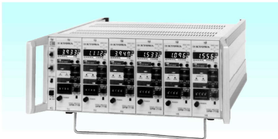
Несколько приборов DPM-700B, установленных в портативном корпусе YB-506A
