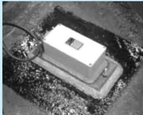
Сенсорный блок уклона мостовой опоры
