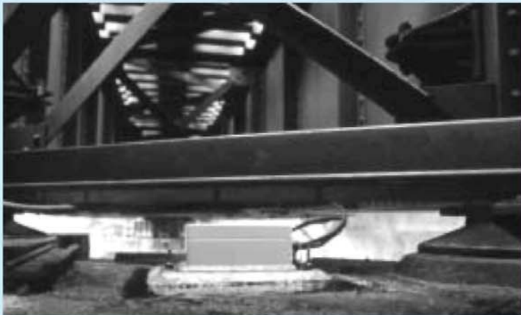
Установленный датчик уклона мостовой опоры
